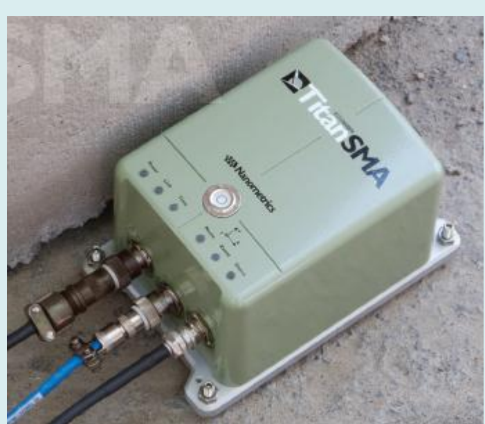
Strumentazione (TITAN) per la calibrazione messa a disposizione dall'INGV di Pisa
