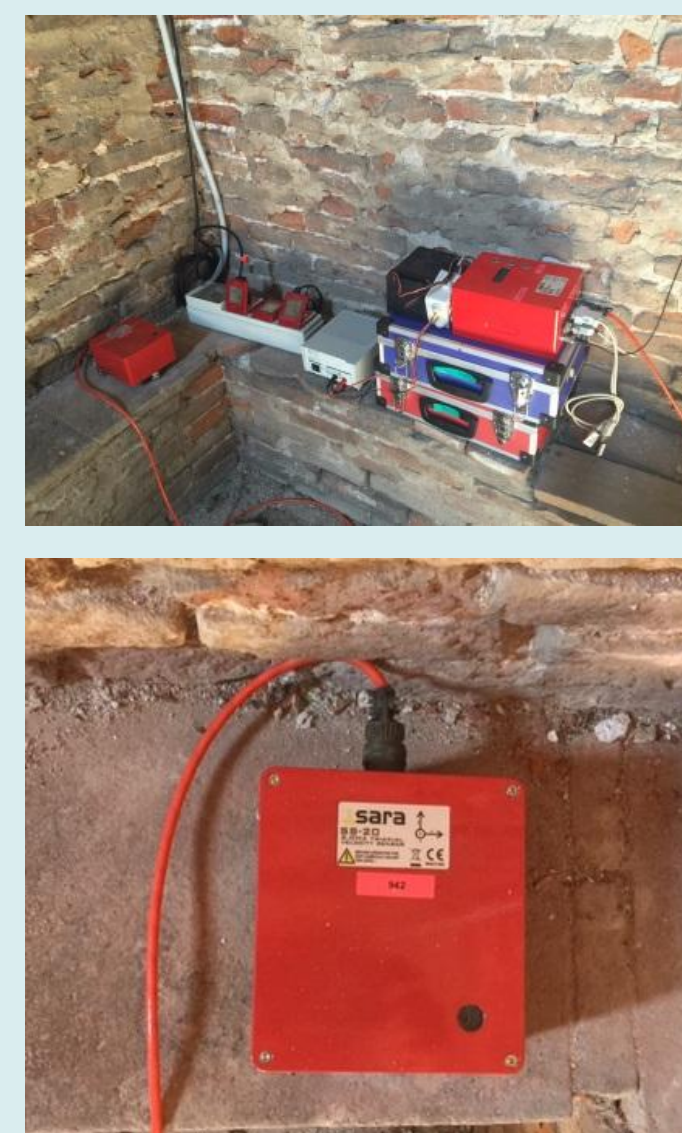
Applicazione di sismometri SARA SS20 sul campanile messi a disposizione dall'INGV di Arezzo
